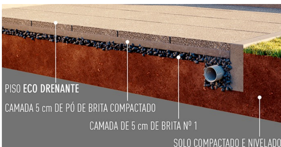
Imagem: modo de assentamento do piso drenante
